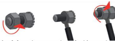
Conexión del equipo a una instalación equipotencial.
